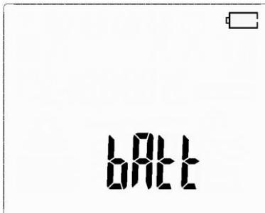
Die Meldung **bAtt** gibt an, dass die Batterien/Akkus vollkommen entladen sind. Alle Messungen sind blockiert und das Gerät schaltet sich nach 5 Sek. automatisch ab.
